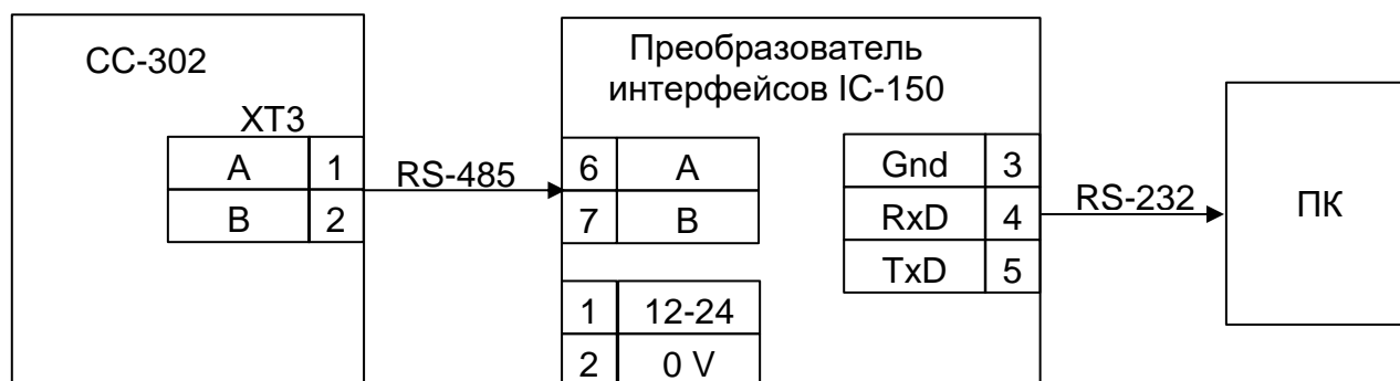
Рисунок Д.2 – Схема подключения счетчиков к компьютеру по интерфейсу RS-485
